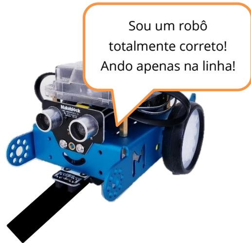
O mBot possui um módulo seguidor de linha com dois 2 sensores infravermelhos, um à direita e outro à esquerda, que formam seu seguidor de linha. O seguidor de linha do mBot pode detectar uma superfície branca na faixa de 1 a 2 cm de distância do sensor. Para implementar um programa que atribua ao mBot a função de robô seguidor de linha, é necessário atentar para as diferentes situações que podem ocorrer:
